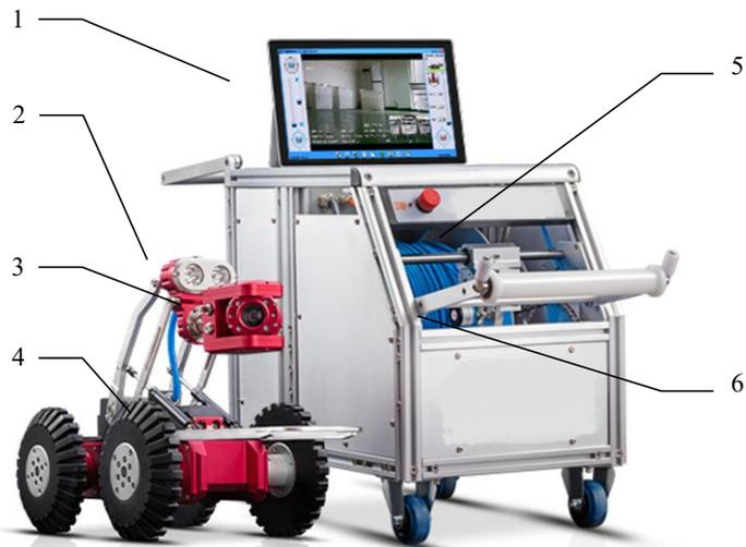
图1 管道电视检测仪结构示意图
