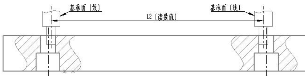
图5 圆柱形测头中心距卡尺的中心距测量示意图
